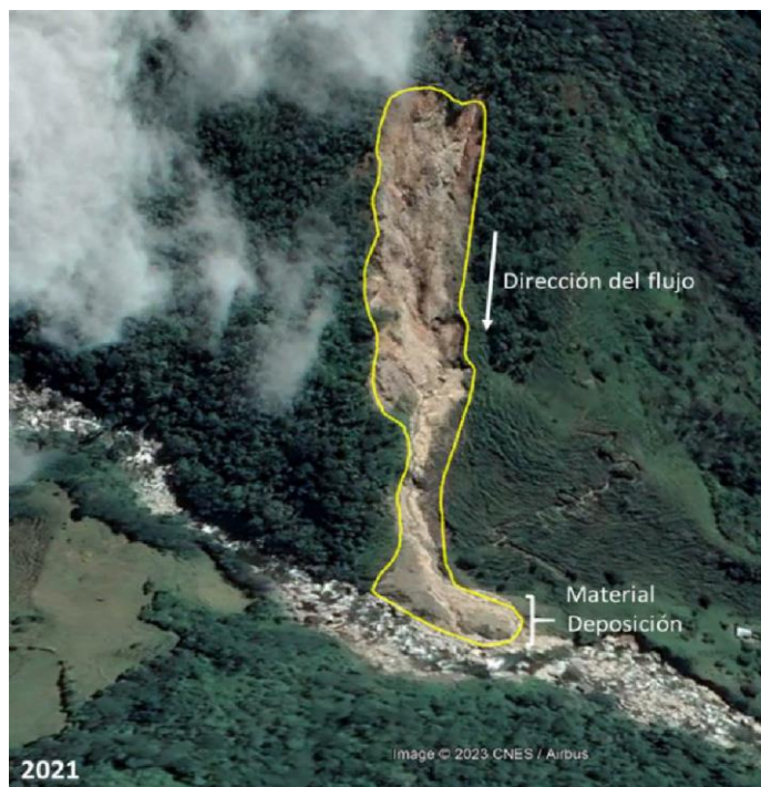
Movimientos en masa, Flujo, área rural municipio de San Carlos, Fuente: Google Earth 2021.
