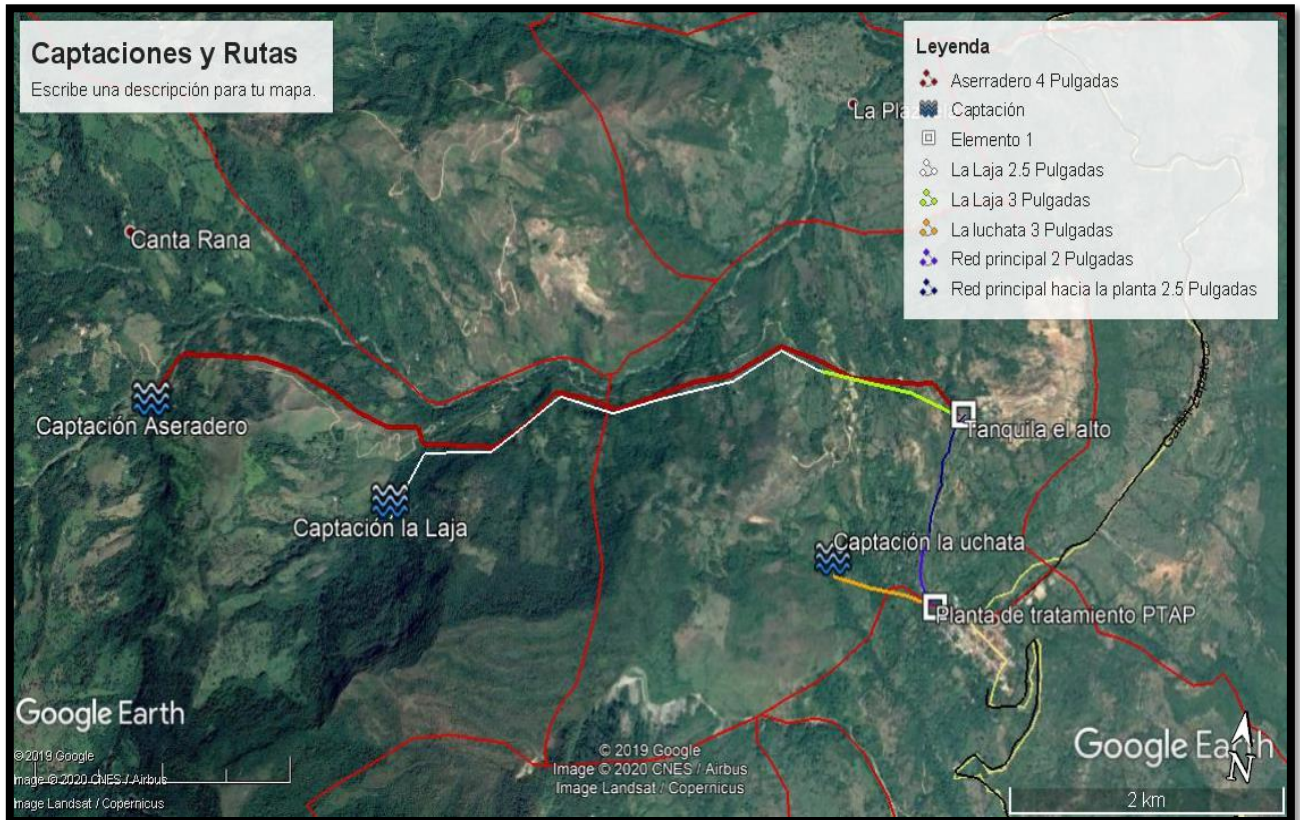
Imagen 12. Diagrama de tubería del acueducto municipal
