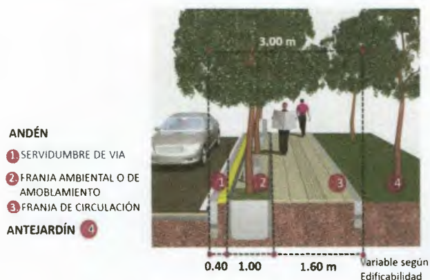
Gráfica N° 6. Sección del andén mínimo en sectores residenciales con franja ambiental (3.00 m).
