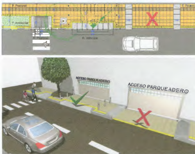
Gráfica N° 16. Rampas vehicular y peatonal en andenes de tres metros (3 m) en adelante.
