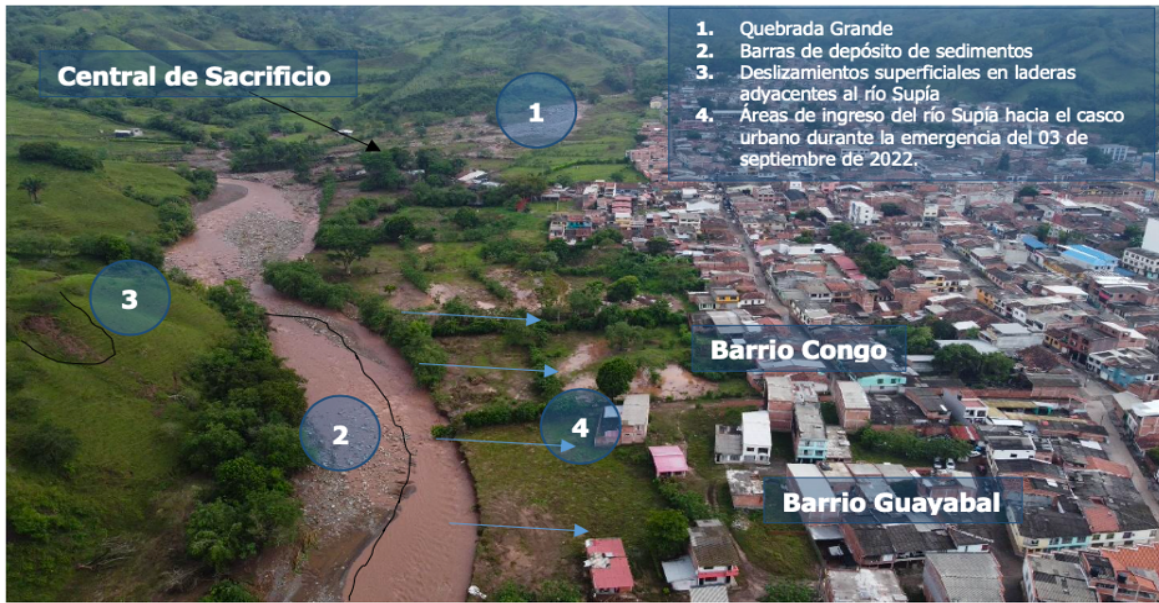
Imagen 4 Desbordamiento del río Supía en el sector de los Barrios Congo y Guayabal
