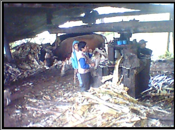
FOTO 31. MOLIENDA DE CAÑA A TRAVÉS DE BUEYES (IZQ.) Y COCIMIENTO DEL JUGO DE CAÑA (DER.)
