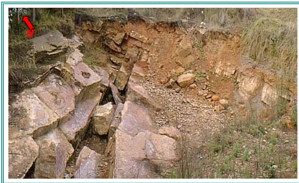
FIGURA No. 11 ROCA ARENISCA DE LA FORMACIÓN CHURUVITA, EXPLOTADA PARA CONSTRUCCIÓN
