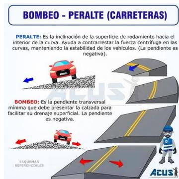
*Nota:* En la figura se detalla la diferencia entre peralte y bombeo, estos dos elementos deben estar diseñados conforme a las necesidades y especificaciones únicas del terreno para poder garantizar seguridad a los usuarios y a la extensión de la vida útil de la vía.
