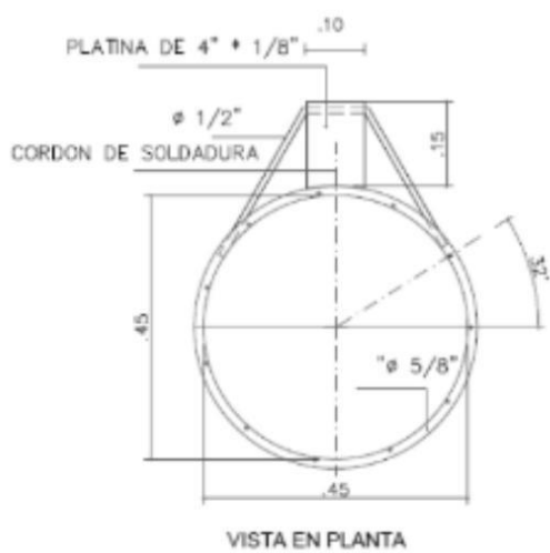
DETALLE ARO DE BALONCESTO ESCALA ___ 1: 10
