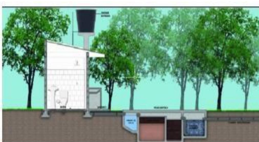
Figura 9. Conexión de unidad sanitaria a filtro FAFA. Fuente: PROYECTOS TIPO DNP
