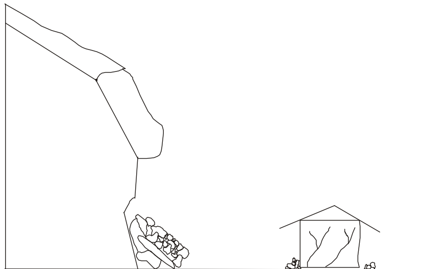
Caídos de bloques por gravedad en roca fracturada
