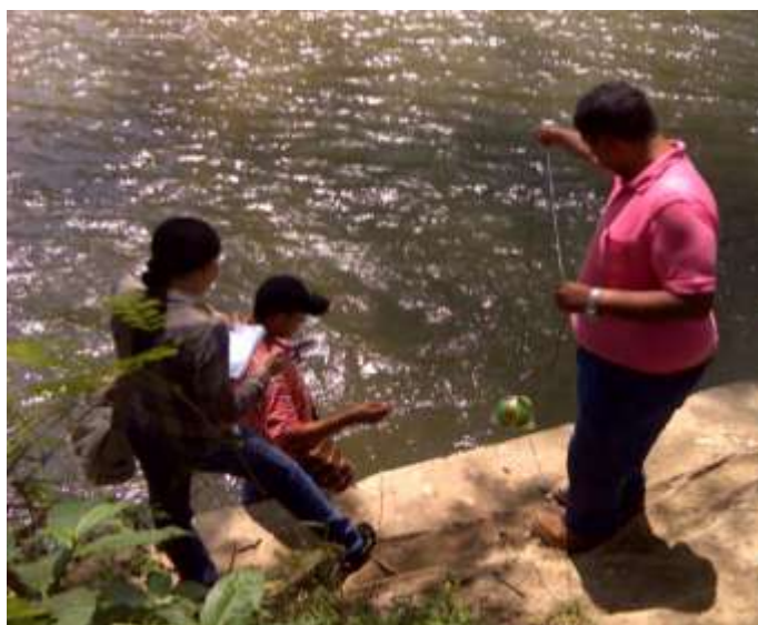
Foto 1. Medición de velocidades (punto de control Río frio)
