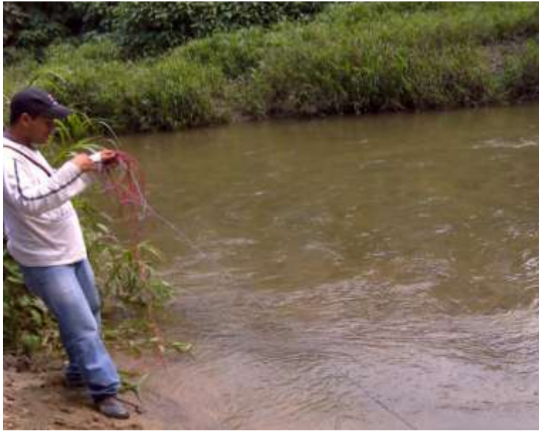
Foto 2. Medición de velocidades (punto de control Rio Sevilla)
