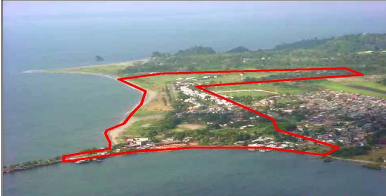
Fotografía de los Sectores 18 y 19 con alto potencial de licuación, sobre rellenos hidráulicos. Fuente: Evaluación de la vulnerabilidad física por terremoto y sus fenómenos asociados en poblaciones del Litoral de Nariño. 2003.
