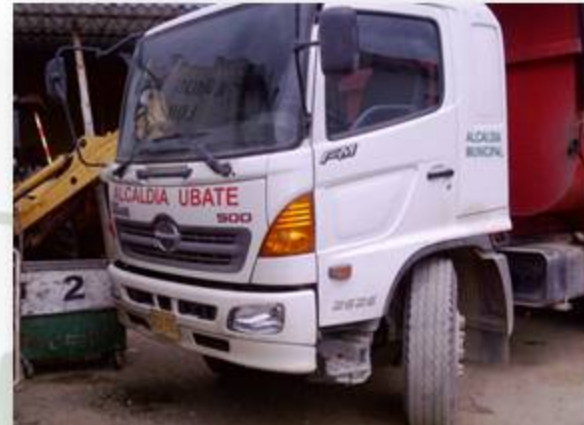
VOLQUETA DOBLE TROQUE, NO CUENTA CON SISTEMA DE COMPACTACIÓN
