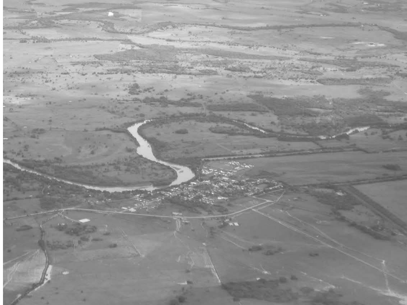
Figura 3.5 Meandro natural del río Pauto que afecta por socavación lateral al casco urbano del municipio de San Luis de Palenque
