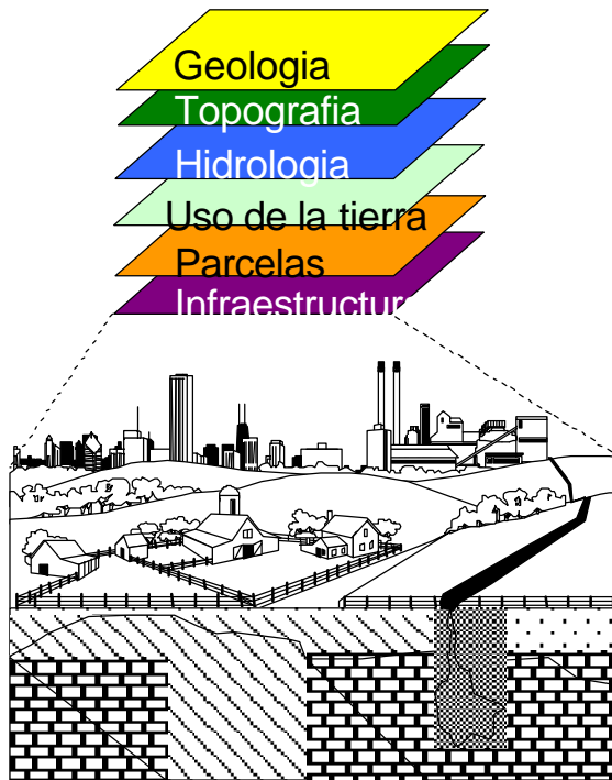
Figura B. El SIG permite el análisis de información espacial georreferenciada en multicapas, lo cual arroja una comprensión mayor de la problemática territorial.
