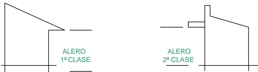
Alero 1: es una prolongación de la cubierta inclinada sobre la vía y su longitud es de 50 cm y 1 mts aprox.
