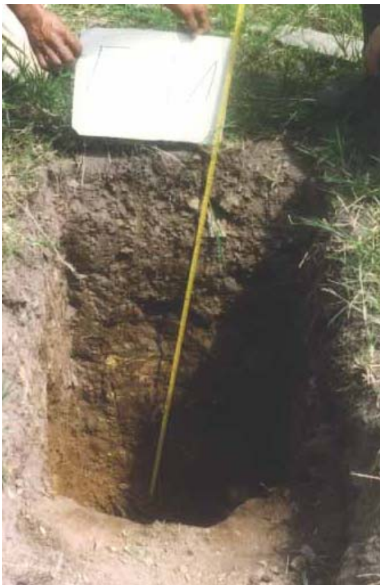
FOTO N°13. PERFIL CA-1 Typic Haplustepts vereda Misiones 00 - 57cm. Color en húmedo gris (10YR6/1); textura franco arenosa;
