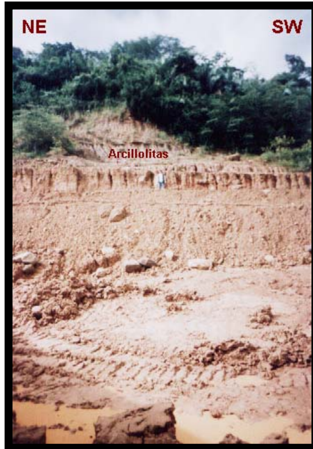
Figura 5 Estratos Métricos de Arcillolitas de Color Rojo y Gris Intercalados con Estratos de Areniscas Cuarzosas Perteneciente a la Formación Gualanday Inferior. Tomado en la Cantera de Arcilla de la Ladrillera la Milagrosa.
