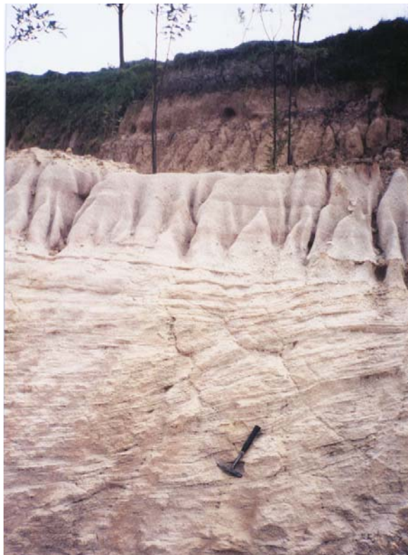
Figura I.7. Depósito sedimentario cuaternario en capas finas, con baja consolidación y compuesto de caolín, arenisca blanca fina, limos y posiblemente cenizas.
