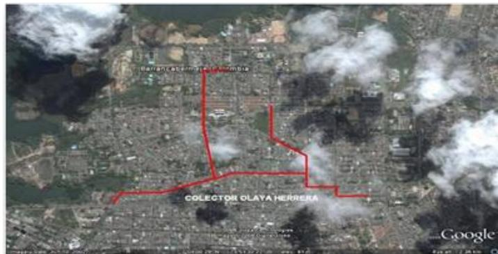
**Colector Comuna 1.** Este colector es existente, recoge las aguas residuales de los barrios: Palmira, Inscredial, El Recreo, Colombia y Buenos Aires. Las aguas residuales de este colector serán interceptadas a la altura de la calle 52 con carrera 12 por el Colector Ferrocarril. Tiene una longitud de 3440 m y trazado sobre las Calles 52, 49 y 48.
