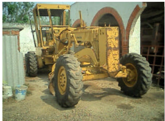
Foto 24. Motoniveladora para el mantenimiento de vías en reparación.
